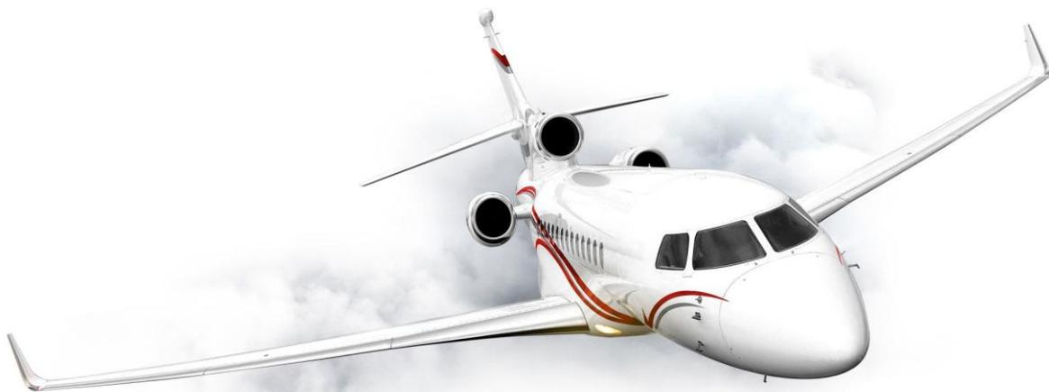
Le Falcon 7X est un triréacteur d'affaire du constructeur DASSAULT capable de franchir une distance de 11 000 km à une vitesse de l'ordre de 900 km/h (mach 0.85).
