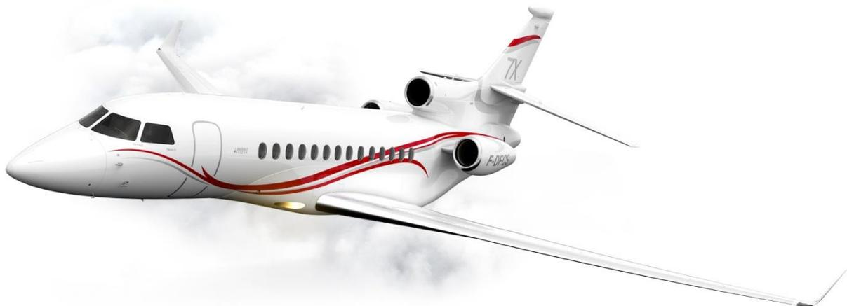
C'est le premier avion au monde à avoir été développé entièrement en maquette numérique : aucun prototype ni maquettes n'ont été réalisés. Cet avion est équipé de commandes de vol électriques.
